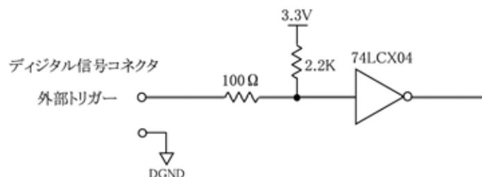
図 4.7 外部トリガー入力回路
